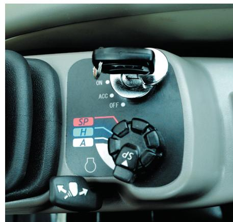
Операторы могут вносить до **10 дополнительных настроек расхода гидравлического масла** (и давления гидравлического масла — опция по заказу), что позволяет им легко и быстро менять навесное оборудование без необходимости каких-либо механических регулировок.
