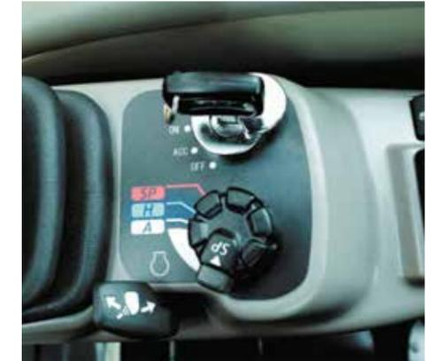
Операторы могут сохранять до **десяти дополнительных настроек расхода гидравлического масла** (и давления гидравлического масла — опция по заказу), что позволяет им легко и быстро менять навесное оборудование без необходимости каких-либо механических регулировок.
